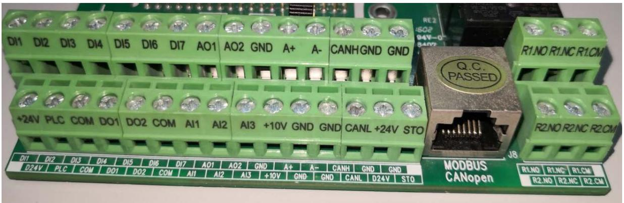
图 3.3 控制板端子图（详细功能参见 P20 页图 3.6 标准接线图）
